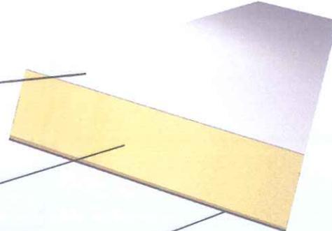
1 y 3. Chapa de aluminio termolacada Diferentes terminaciones en lacados RAL, anodizados, lacados maderas y otros.
